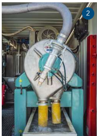
Fig. 2 - Uscita dell'acqua chiarificata dal decanter centrifugo dopo la separazione
