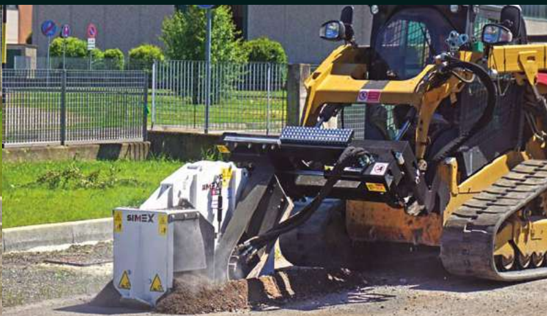
RW 350 PER PALE COMPATTE LARGHEZZA SCAVO: da 25 a 80 mm PROFONDITÀ SCAVO: da 250 a 350 mm
