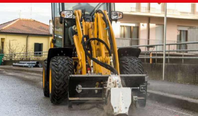
RW 150 PER PALE E PALE COMPATTE LARGHEZZA SCAVO: da 25 a 50 mm PROFONDITÀ SCAVO: da 100 a 150 mm
